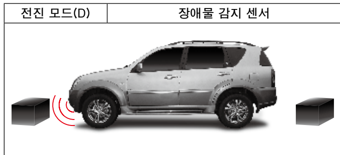
차량 전진 모드(D)에서 전방 장애물 감지 센서가 작동
