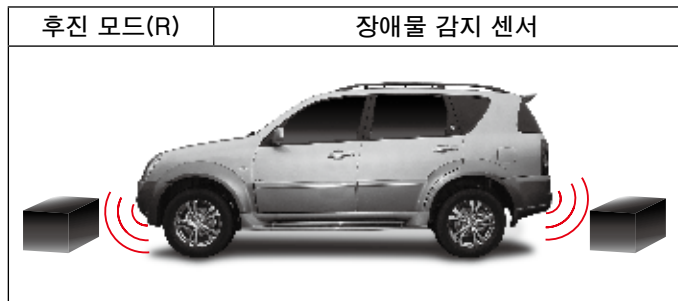
차량 후진 모드(R)에서 전/후방 장애물 감지 센서가 작동
