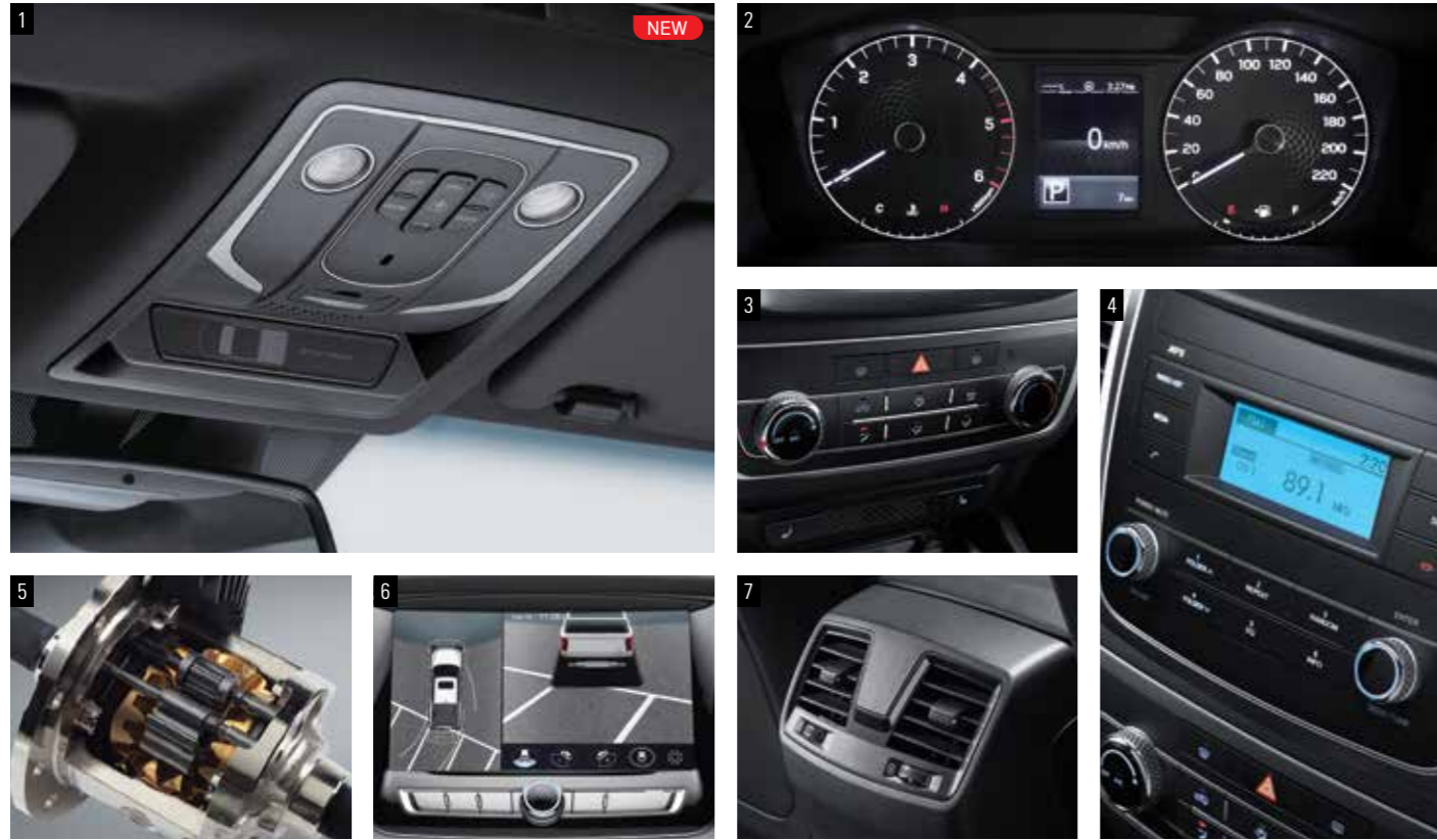
1. 뉴 오버헤드 콘솔 & LED 룸램프 2. 슈퍼비전 클러스터(3.5인치 모노 LCD) 3. 메뉴얼 에어컨 4. MP3 오디오 5. LD 시스템 6. 3D 어라운드 뷰 시스템 7. 2열 에어벤트
