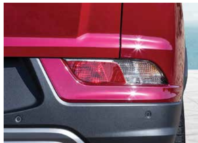
LED 리어 콤비램프 (LED 제동등, LED 미등) 보조램프 (리플렉스 리플렉터, 후진등, 방향지시등)
